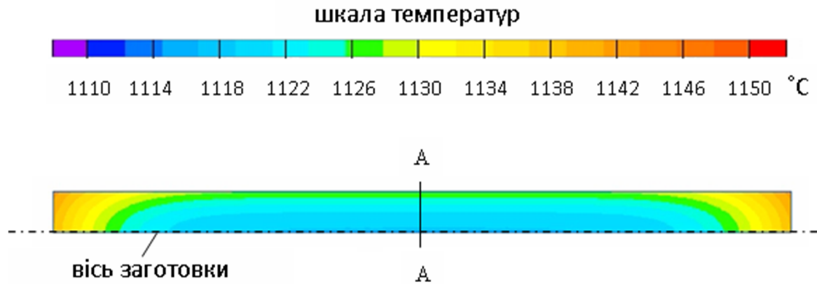
Рисунок 5 – Температурне поле заготовки на виході із томильної зони
