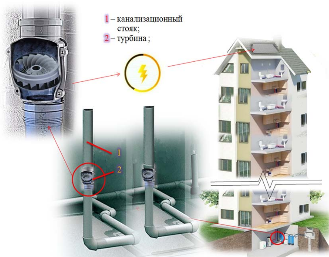
Рисунок 4 – Устройство двухтрубной системы водоотведения
