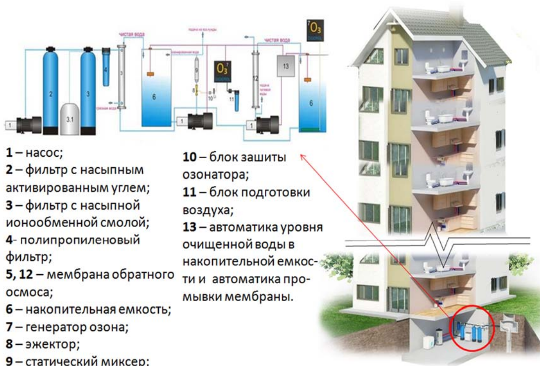
Рисунок 2 – Расположение обратноосмотической установки в жилом доме
