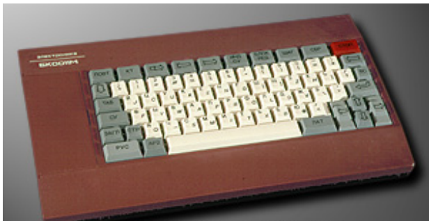
Рис. 1.5 Комп'ютер "Электроника ВК-0011М"
