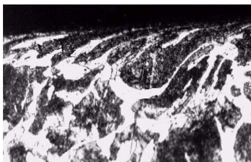
Рис. 2. Микроструктура поверхностей образцов ( \times 500 ): а – после обработки ультразвуком; б – после совместной обработки ультразвуком и геомодификатором трения
