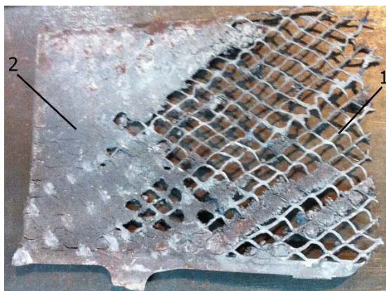
Рисунок 4 – Аккумуляторная пластина: 1 – свинцовая решетка, 2 – сульфатно-оксидная составляющая
