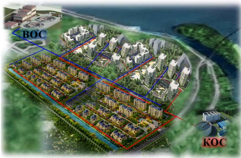
Рисунок 1 – Схема совместного водоснабжения и водоотведения центральной части г. Днепропетровска
