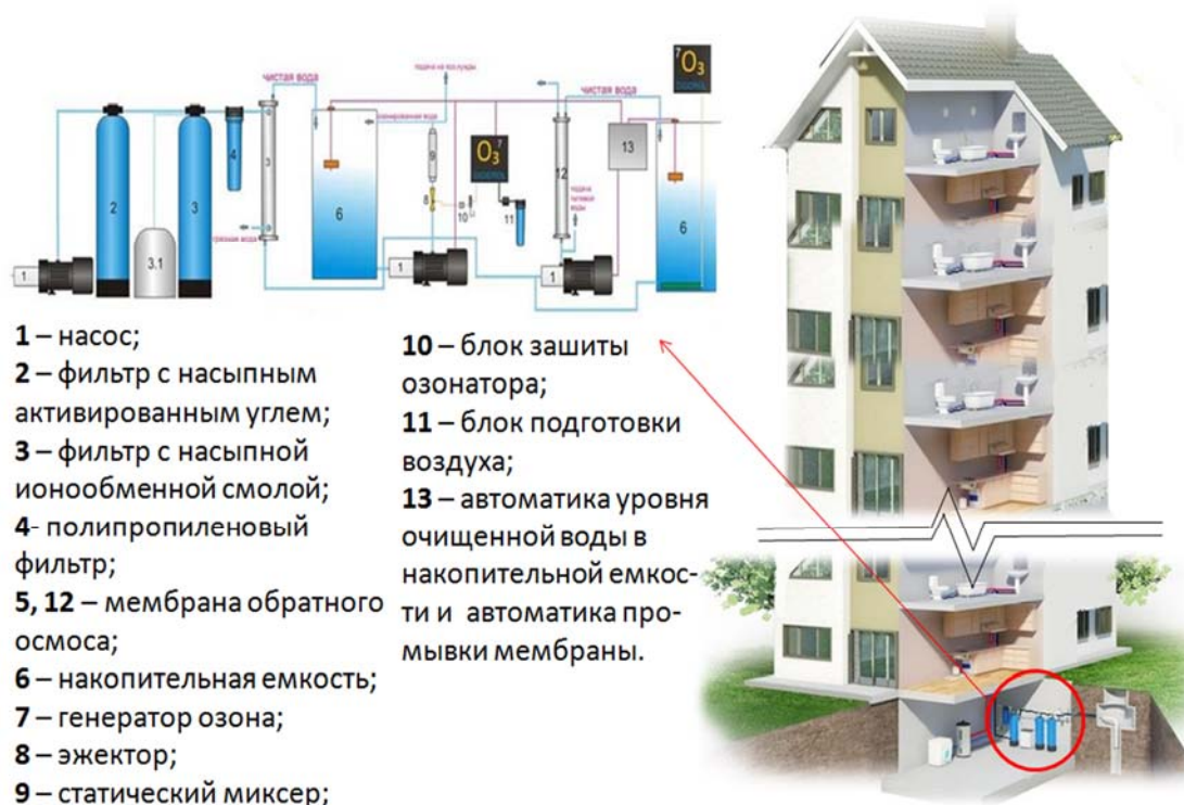
Рисунок 2 – Расположение обратноосмотической установки в жилом доме
