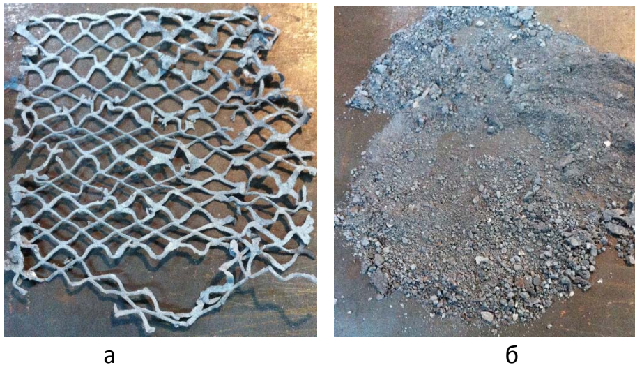
Рисунок 5 – Результат дробления аккумуляторной пластины: а – свинцовая решетка, б – сульфатно-оксидная фракция
