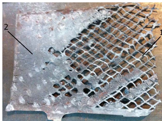
Рисунок 4 – Аккумуляторная пластина: 1 – свинцовая решетка, 2 – сульфатно-оксидная составляющая
