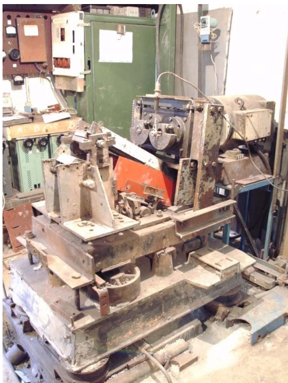
Рисунок 2 – Вибрационная щековая дробилка с наклонной камерой дробления
