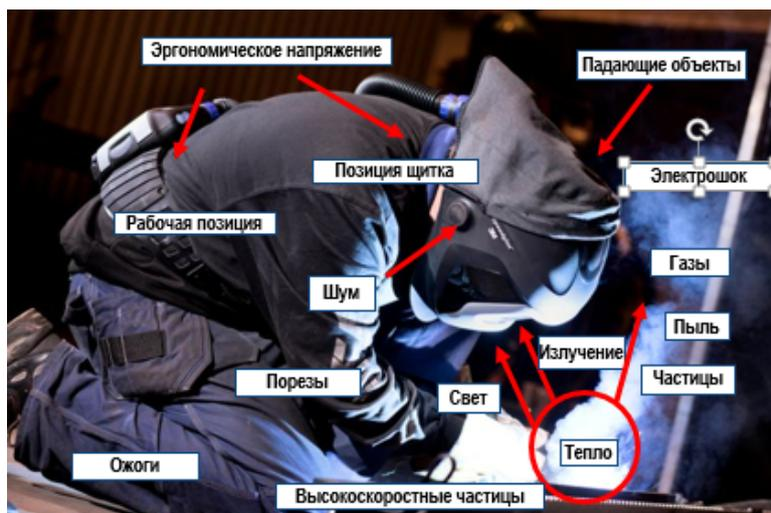
Рис. 15. – Комплексное защитное средство от шума, пыли и инфракрасного излучения Speedglas 9100 от фирмы 3М
