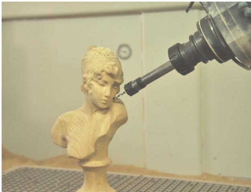
Рисунок 5 – Фрезерная обработка детали на высокоскоростной 5-ти осевой станок с ЧПУ
