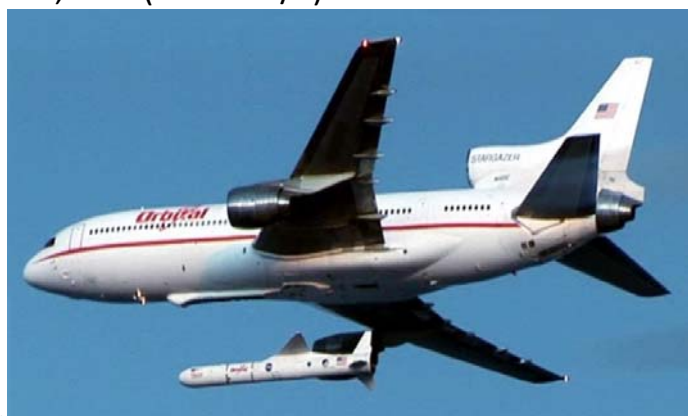
Рисунок 2 – Старт РН «Пегас» с самолета-носителя «Старгейзер».
