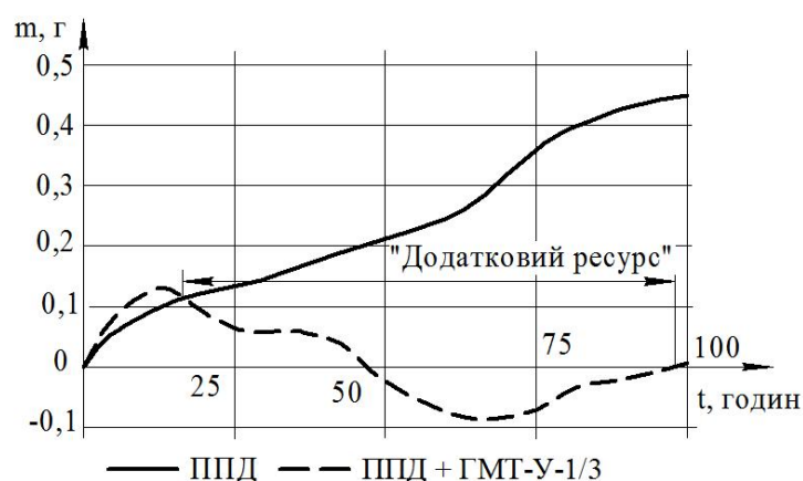
Рисунок 2 – Графік зносу зразків зі сталі 40Х
