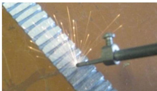
Рисунок 4 – Процес нанесення покриття при ЕІЛ
