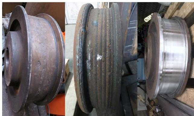
Рисунок 1 – Ходові колеса з зносом
