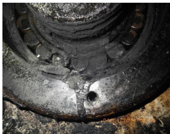
Рисунок 2 - Типові руйнування підшипників скребкового конвеєру гіпербарфільтру
