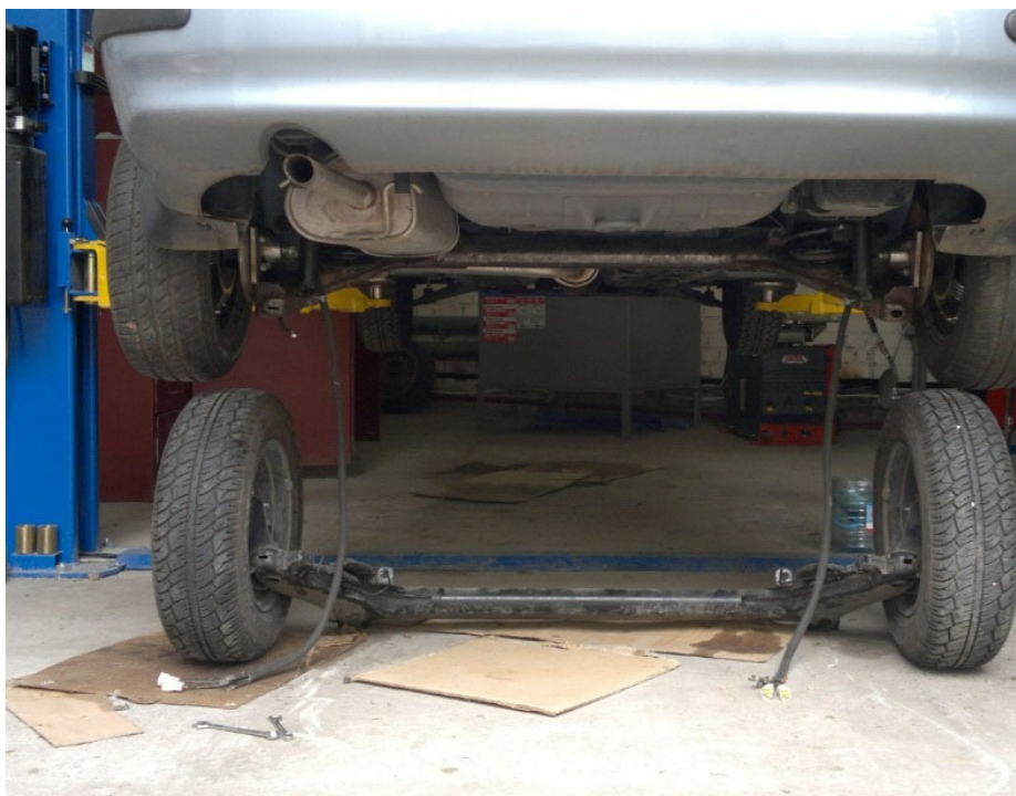
Рисунок 2 – Заміна задньої балки автомобіля ЗАЗ СЕНС
