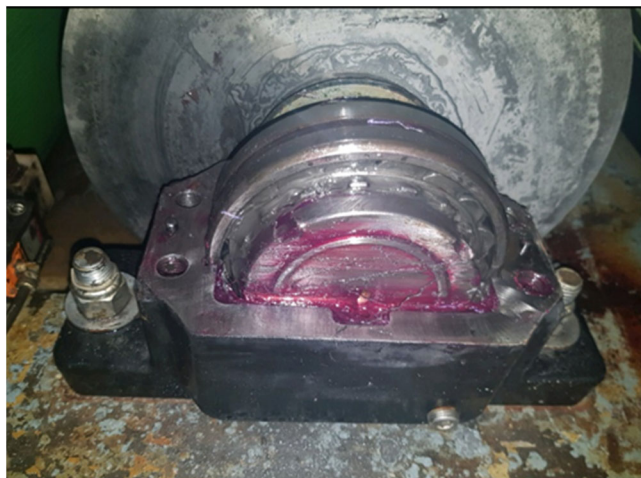
Рисунок 2 – підшипник 22217ЕК у вузлі
