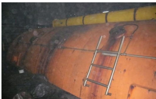
Рисунок 1 - Гіпербарфільтр: а) «Збагачувальна фабрика «Свято-Варваринська»; б) схема фільтра
