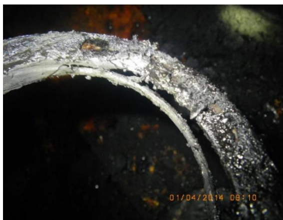
Рисунок 2 - Типові руйнування підшипників скребкового конвеєру гіпербарфільтру
