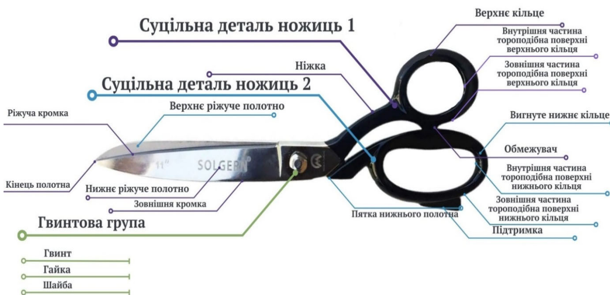
Рис. 3. – Схема деталей та елементів кравецьких ножиць «SOLGERN №8»
