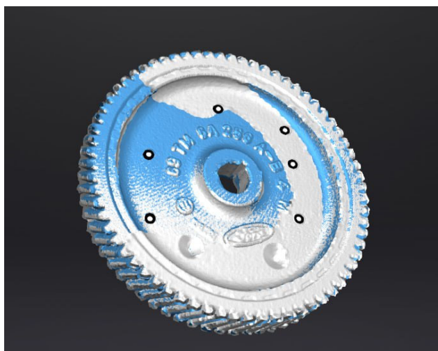
Рис. 3. - Полігональна модель деталі, що сканувалася
