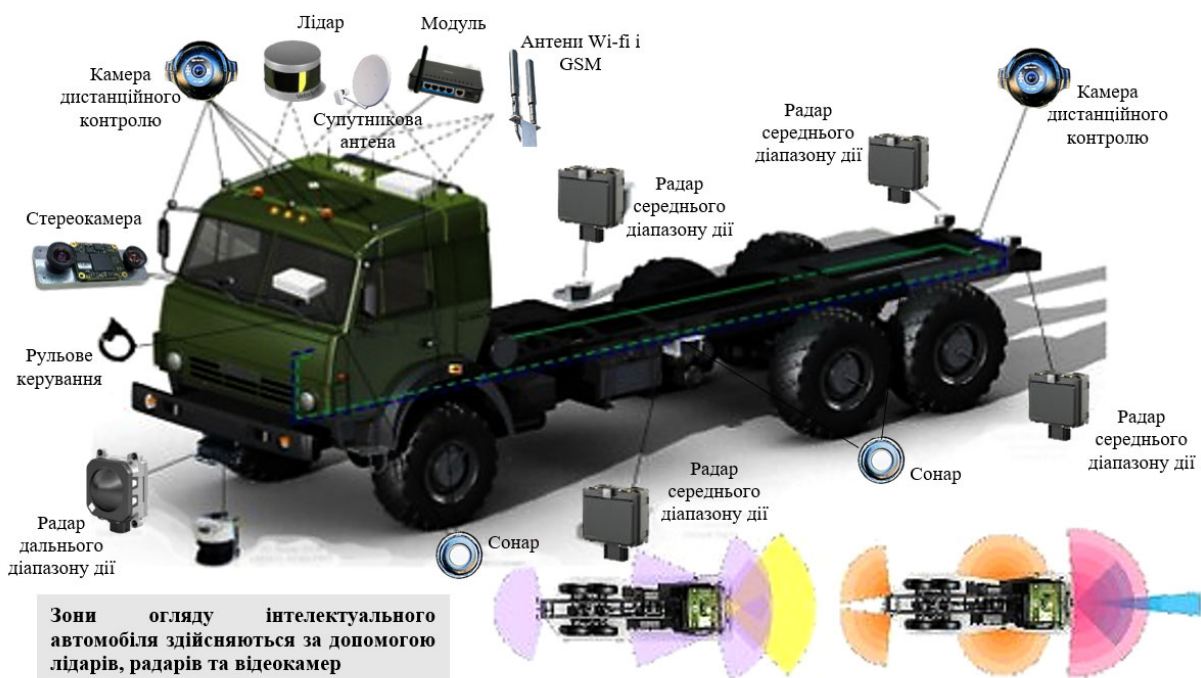
Рис. 7. – Компоненти систем керування рухом інтелектуального автомобіля
