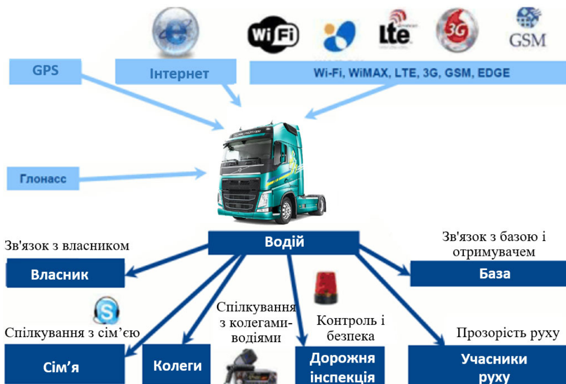
Рис. 6. – Системи зв'язку інтелектуального автомобіля
