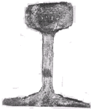
Рис. 4. 4. Ліквація сірки в сталі
