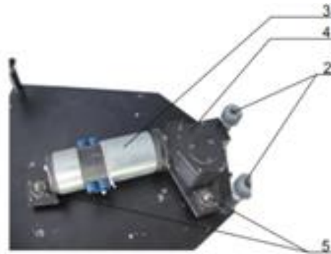
Рис. 3. Блок електроприводу (Вид знизу зі знятим захисним кожухом)
