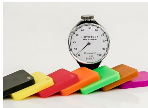
Рис. 3. Твердомір по Шору (аналоговий) з комплектом мір твердості для перевірки і налаштування твердомірів
